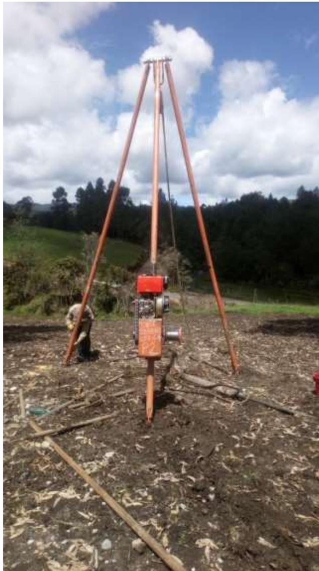
Entre 0,00 y 2,50 mts. de profundidad se encuentra un limo arcilloso grisáceo con materia orgánica negruzca; subyaciendo y hasta los 4,50 mts. una arena limo arcillosa color gris con motas rojas; de allí y hasta los 7,50 mts. una arena arcillo limosa gris amarillenta; el nivel freático se evidenció a 7,00 mts. A continuación, se presentan las características geomecánicas del segundo y tercer estrato respectivamente:
